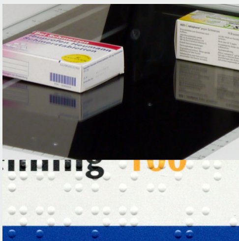
Контроль качества печати и шрифта Брайля на картоне
